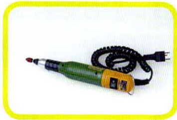
Schleifgerät zum Entfernen von Lack am Heizkörper
